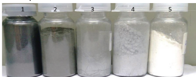
Fig. 6 De izquierda a derecha: Muestras correspondientes al procedimiento según IV3. (1). Grafito - Relaciones de recubrimiento GRA:OCLBI (2) 70:30 - (3) 30:70 - (4) 10:90 - (5) OCLBi puro.
